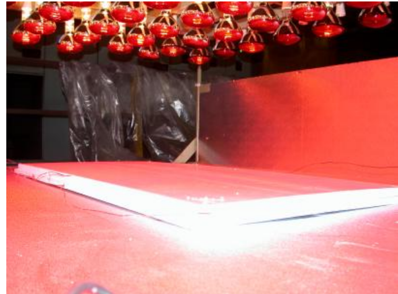
PROVA DI STABILITA' SOTTO IRRAGGIAMENTO (UEAtc)
